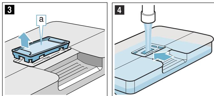
7. Снова установите крышку **a** в отверстие на резервуаре для воды.
