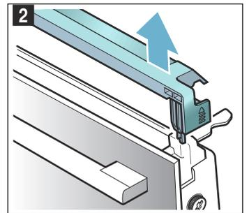
**Указание:** Очистите вставку из нержавеющей стали в защитной панели средством для очистки изделий из нержавеющей стали. Очистите оставшуюся часть защитной панели дверцы мягкой тряпочкой с тёплым мыльным раствором.
