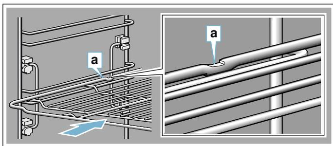
При установке противней следите за тем, чтобы фиксирующий выступ **a** находился сзади и был обращён вниз. Скошенный край противня **b** должен быть обращён вперёд к дверце прибора.
