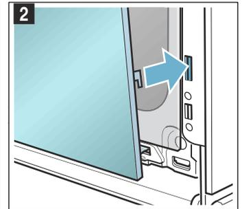
3. Нажмите на переднее стекло так, чтобы оно зафиксировалось со слышимым щелчком (рис. 3).
