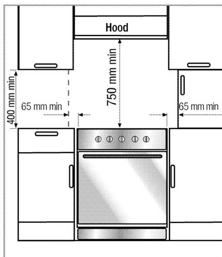
Для безопасности устанавливайте прибор на некотором расстоянии от мебели и от стены помещения. См. рисунок (размеры приведены в миллиметрах).
