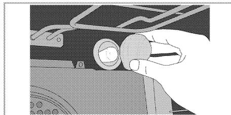
3. Вывинтите лампу духовки, поворачивая ее против часовой стрелки, и замените ее новой.
