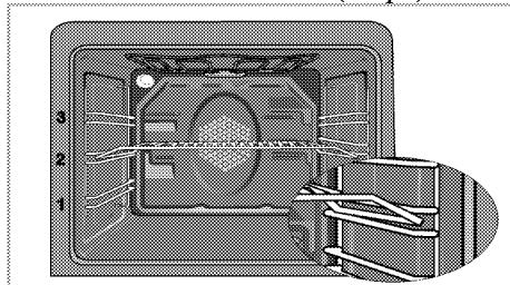
Важно правильно установить проволочную решетку на проволочную полку. Проволочную решетку следует установить так, чтобы она вошла в отверстие на проволочной полке, как показано на рисунке.
