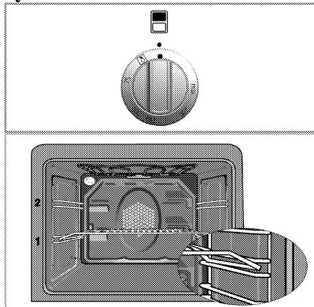
Важно правильно установить проволочную решетку на проволочную полку. Проволочную решетку следует установить так, чтобы она вошла в отверстие на проволочной полке, как показано на рисунке.
