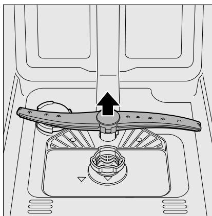
4. Промойте распылительные коромысла в проточной воде.
