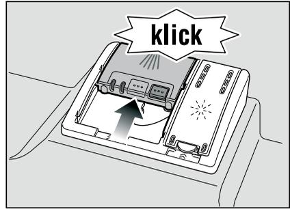
Камера с моющим средством открывается автоматически в зависимости от выбранной программы в самый подходящий для этого момент времени. Порошкообразное или жидкое моющее средство распределяется внутри машины и затем растворяется, таблетка падает в предназначенную для нее подставку и, находясь в ней, постепенно растворяется.
