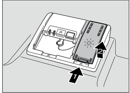
2. Осторожно залейте ополаскиватель в отверстие до отметки максимального уровня.
