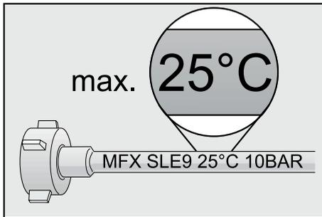
Для всех других моделей: предпочтение отдается холодной воде; при подаче горячей воды макс. температура ее нагрева не должна превышать 60 °С.
