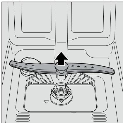
4. Промойте распылительные коромысла в проточной воде.
