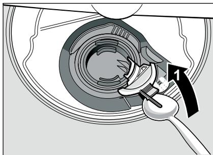
6. Проверьте, не застряли ли между лопастями крыльчатки посторонние предметы и удалите их при наличии.
