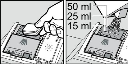
2. Закройте крышку камеры для моющего средства, перемещая ее вверх до тех пор, пока замок не закроется.
