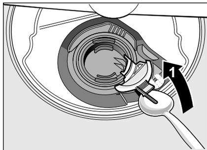
6. Проверить крыльчатку на наличие посторонних предметов и, при необходимости, удалить их.
