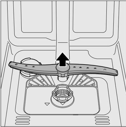
4. Промойте распылительные коромысла в проточной воде.
