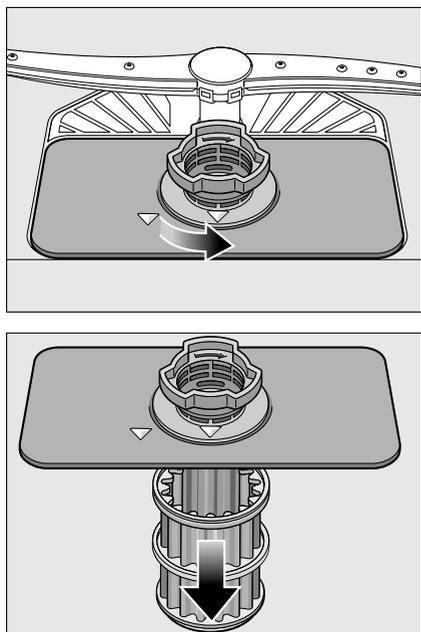
3. При необходимости удалите из фильтров остатки загрязнений и промойте фильтры в проточной воде.
