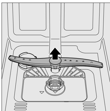
4. Промойте распылительные коромысла в проточной воде.
