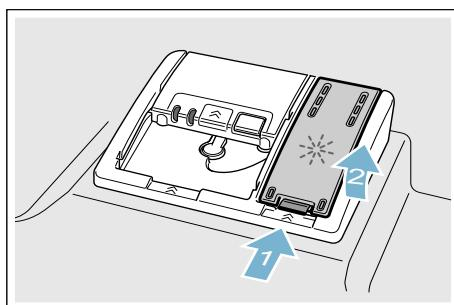
2. Заполнить ополаскиватель до отметки «max.».
