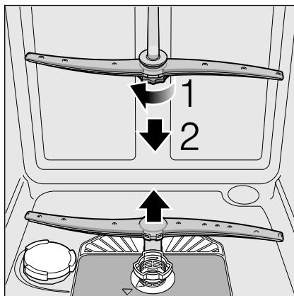
4. Промойте распылительные коромысла в проточной воде.
