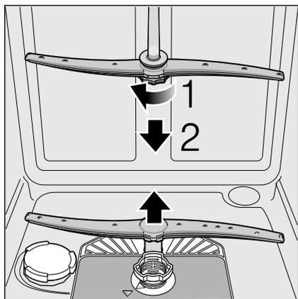
4. Промойте распылительные коромысла в проточной воде.
