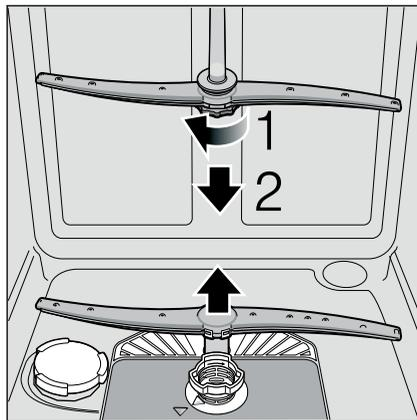
4. Промойте распылительные коромысла в проточной воде.
