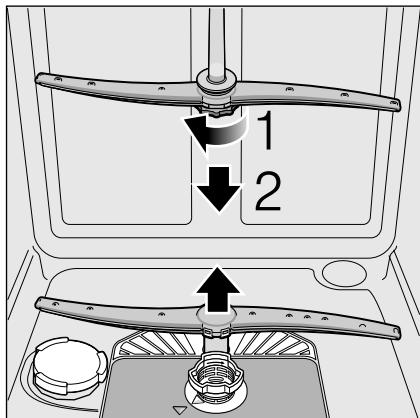
4. Промойте распылительные коромысла в проточной воде.
