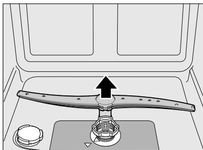
3. Промойте распылительное коромысло в проточной воде.
