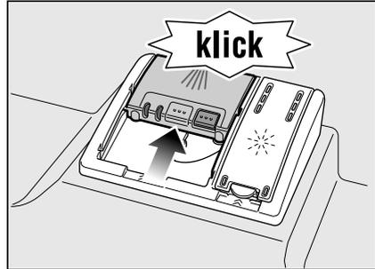
Ячейка с моющим средством открывается автоматически в зависимости от выбранной программы в самый подходящий для этого момент времени. Порошкообразное или жидкое моющее средство распределяется внутри машины и затем растворяется. Таблетка моющего средства падает в машину и там растворяется.
