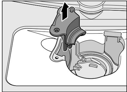
5. Проверить внутреннюю полость насоса, и, при необходимости, удалить посторонние предметы.
