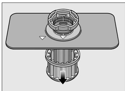
3. При необходимости удалите из фильтров остатки загрязнений и промойте фильтры в проточной воде.
