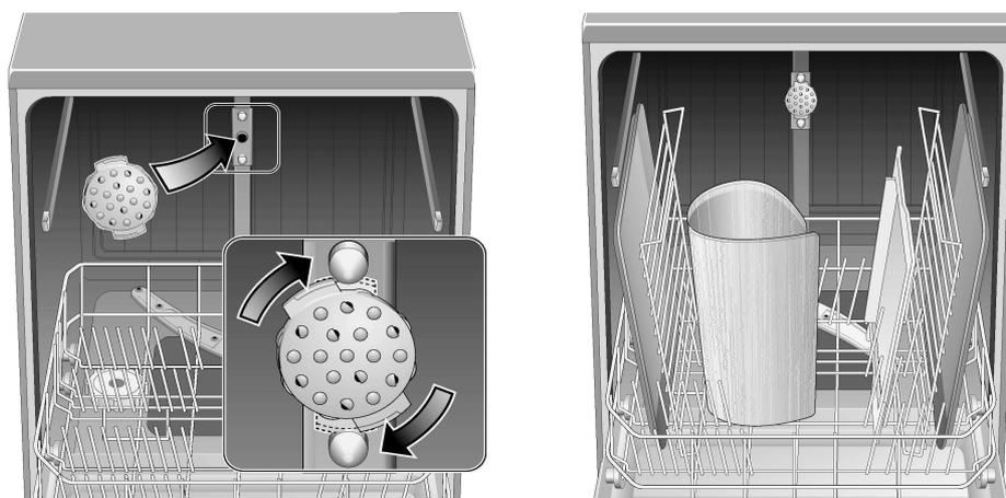
С помощью этой разбрызгивающей головки Вы можете помыть большие противни или решетки, а также тарелки диаметром более 30 см (тарелки для гурманов, тарелки для спагетти, тарелки-подставки).
