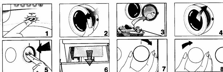
Затем загрузите стиральный порошок и кондиционер в контейнер и закройте его. Важмите кнопку On/Off и включите машину.
