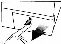
Прежде чем вытаскивать фильтр, слейте воду при помощи установленной внутри сливной трубы. Подготовьте подходящую емкость, откройте заглушку на сливной трубке и слейте воду.
