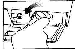
Откройте фильтр, повернув его против часовой стрелки, удалите воду, оставшуюся на крышке фильтра (около 30 мл). Прочистите фильтр, после чего установите его обратно, поворачивая по часовой стрелке и закройте крышку фильтра, нажав на нее в отмеченном месте.
