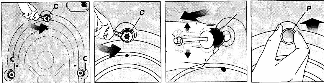
Болты, на головках которых имеется обозначение «С» выворачивать против часовой стрелки до тех пор пока они без труда могут быть вытащены.
