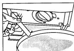
После того, как вся вода слита, закройте заглушкой сливную трубку, и закрепите ее на место.
