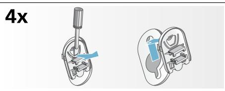
2. Вставьте все 4 втулки. Зафиксируйте сетевой кабель в держателях. Вставьте винты и затяните их.
