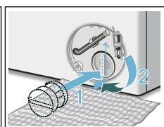
6. Установите крышку отсека для сервисного обслуживания на место.
