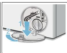
4. Выньте сливной шланг с держателя. Снимите крышку, слейте раствор моющего средства в соответствующую ёмкость. Установите закрывающую крышку на место. Вставьте сливной шланг в держатель.
