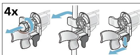
3. Вставьте заглушки. Зафиксируйте заглушки нажатием на стопорные крючки.
