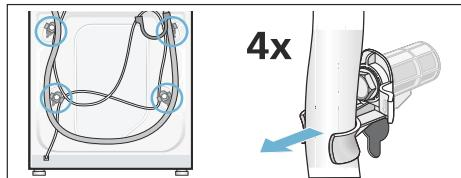
2. Выверните и снимите все 4 винта транспортировочных креплений. Снимите втулки. При этом извлеките сетевой кабель из держателей.
