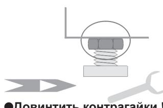
После установки и после выравнивания горизонтального уровня следует проверить её устойчивость путём нажатия каждого угла стиральной машины и проверки её стабильности !
