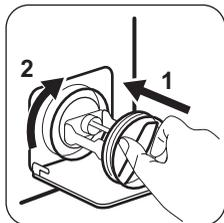
8. Очистите фильтр, находящийся под водопроводным вентиляем, и вставьте его обратно в насос.
