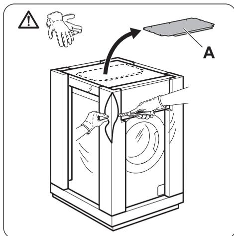
1. Используйте защитные перчатки. При помощи канцелярского ножа снимите закрывающую прибор пленку.
