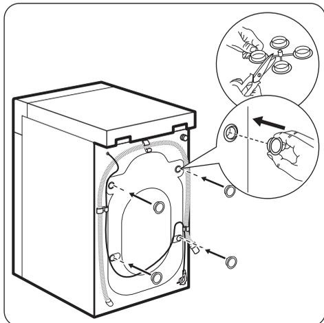
10. Вставьте в отверстия пластиковые заглушки. Заглушки находится в пакете с инструкцией по эксплуатации.
