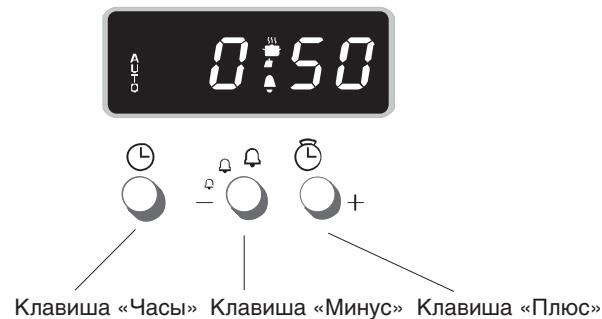
3. Нажмите на клавишу «+» и в течение следующих 10 секунд начните выполнять указания под пунктом 4.
