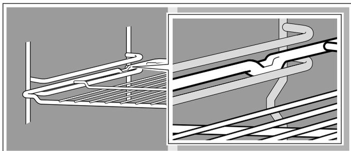
W zależności od wyposażenia, jeśli urządzenie posiada wysuwane szyny, elementy te lekko się zaczepiają po całkowitym wysunięciu. W ten sposób można z łatwością włożyć akcesorium. W celu odblokowania, ponownie wsunąć wysuwane szyny do wnętrza piekarnika, lekko naciskając.
