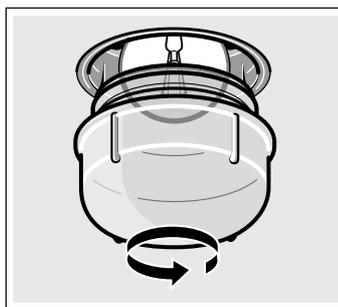
3. Wymienić lampkę na lampkę podobnego typu.
