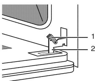
3. Слегка наклоните дверцу духовки.
