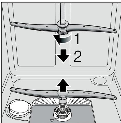
4. Промойте распылительные коромысла в проточной воде.
