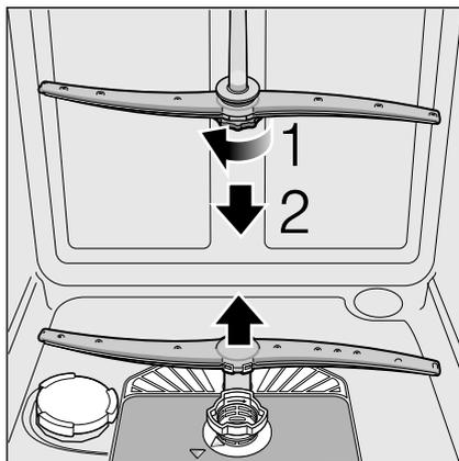
4. Промойте распылительные коромысла в проточной воде.
