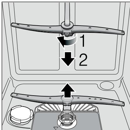
4. Промойте распылительные коромысла в проточной воде.
