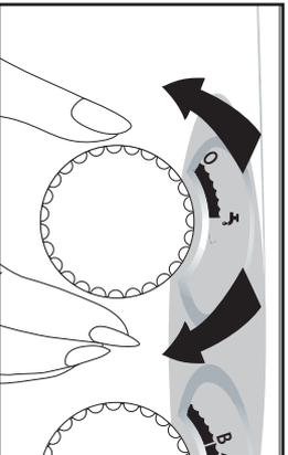
Поверните ручку термостата по часовой стрелке и установите ее на нужную температуру. Если ручка установлена на значок холодной воды "0 3", то стирка производится без подогрева. Поместите стиральный порошок и кондиционер в соответствующие отделения распределителя и закройте его.
