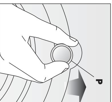
Отверстия для транспортировочных болтов необходимо закрыть прилегающими пластиковыми заглушками, имеющими обозначение "Р", как показано на рисунке.
