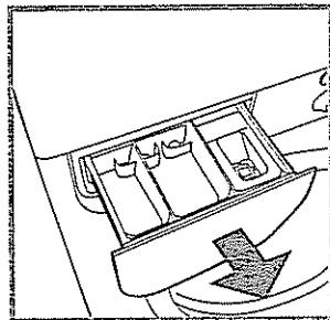
Периодически промывайте распределитель моющих средств. Выньте распределитель, приподняв и потянув его на себя (см. рис.), и промойте под струей воды.
