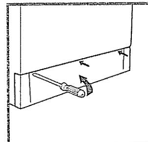
1. снимите переднюю панель стиральной машины при помощи отвертки (см. рис.);
