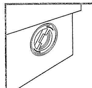
2. выверните крышку фильтра, вращая ее против часовой стрелки (см. рис.); из насоса может выплыть немного воды — это нормальное явление.
