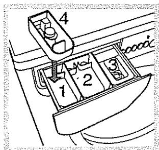
Выдвиньте распределитель и заполните его отделения моющим средством и смягчителем:
