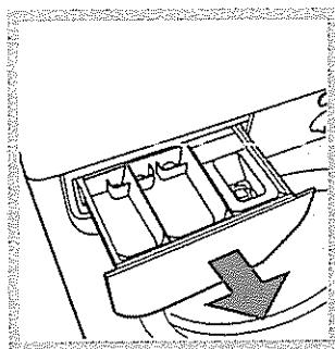
Периодически промывайте распределитель моющих средств: выньте распределитель, приподняв и потянув его на себя (см. рис.), и промойте под струей воды.
