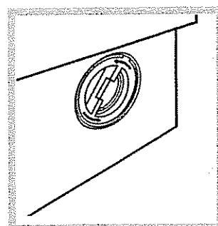
2. Выверните крышку фильтра, вращая ее против часовой стрелки (см. рис.): из насоса может выплыть немного воды — это нормальное явление.
