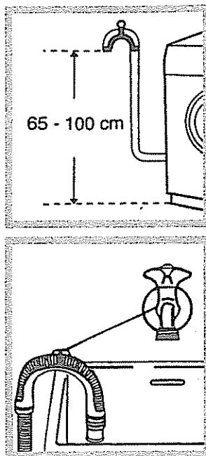
Повесьте загнутый конец сливного шланга на край раковины, ванны или поместите в специальный вывод канализации. Шланг не должен перегибаться. Верхняя точка сливного шланга должна находиться на высоте 65 — 100 см от пола. Расположение сливного шланга должно обеспечивать разрыв струи при сливе (конец шланга не должен быть опущен в воду).
