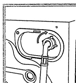
2. Подсоедините заливной шланг к стиральной машине, навинтив его на водоприемник, расположенный в задней верхней части справа (см. рис.).
