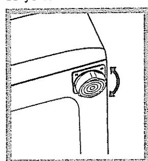
После установки машины на место проверьте по уровню горизонтальность верхней крышки корпуса, отклонение горизонтали должно быть не более 2°.
